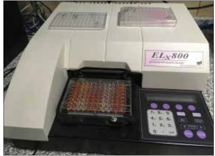
Resim 4. XTT testinde spektrofotometrede hücre kültürü plağının okutulması
